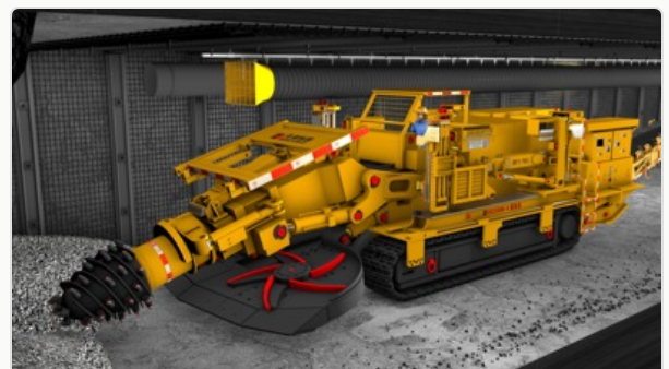
▲ 智能掘锚机 —— 国家级典型应用场景装备
